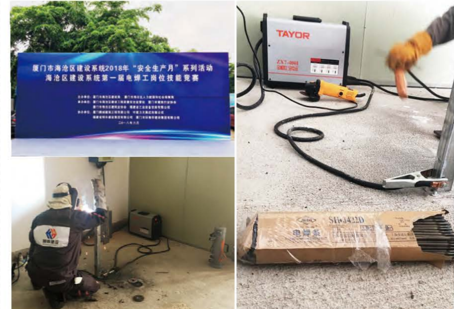
▲ 比赛指定专用电焊机和焊材：ZX7-400I、东风牌焊材
