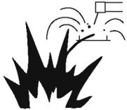
焊接时的飞溅物、焊渣、热工件接触可燃物后会引引起火灾。
