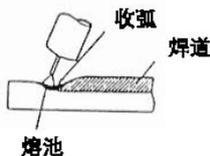
在焊接过程中，收弧处会出现弧坑，由于弧坑出的熔敷金属较少，容易产生气孔及裂纹，因此需要一种合适收弧方式来填补弧坑。
