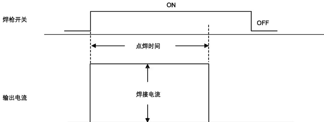
●点焊参数调节仅在点焊模式下有效。
