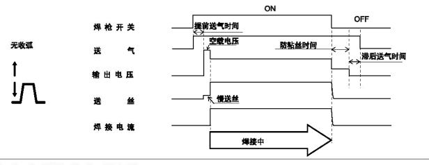
● 按下枪开关开始焊接,松开枪开关停止焊接。
