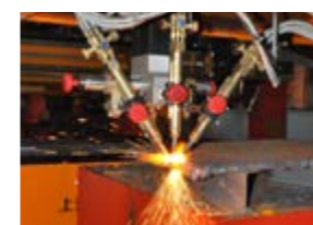
火焰直线三割炬自动转向装置(专利号: ZL.201420038391.1)
